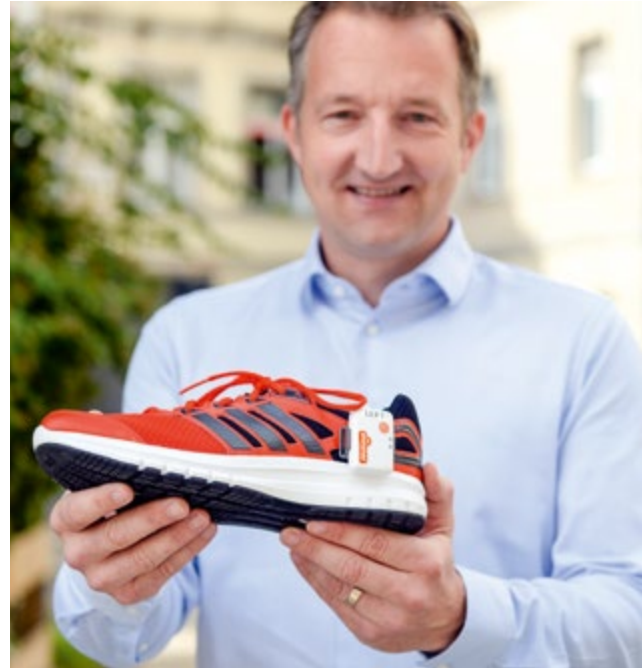
Open Research Challenge 2017 der Universität Erlangen: Jochen Klucken, Professor am Universitätsklinikum, zeigt ein am Schuh montiertes mobiles Sensorsystem zur automatisierten Ganganalyse aus dem Projekt eGaIT
