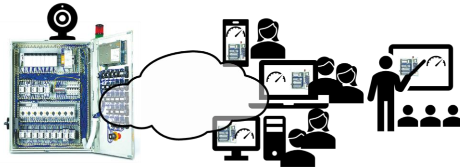
Abb. 5 digitaler Laborversuch: Vorrorausschauende Instandhaltung in Anlehnung an Industrie 4.0. Betriebszustände einer Schaltanlage [10] werden überwacht: thermische Überwachung, Umgebungsüberwachung, Überwachung einer Transformatorwicklung. Zu- und wegschalten von Lasten. Die Studierenden treten in Interaktion mit der Anlage, als ob Sie davorstehen.
