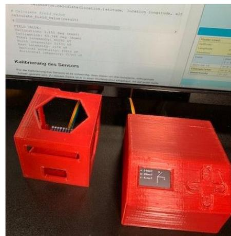
Abbildung 4: Take Home-Kit zum EFNMR-Versuch. Sensor in Kalibrier-Würfel (links) und Steuerung. Im Hintergrund das Jupyter-Notebook zum Einlesen der Magnetfeld-Komponenten.
