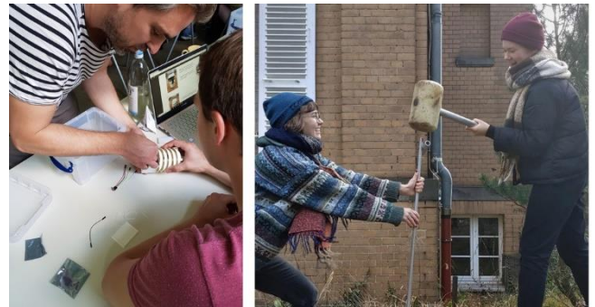
Bau der automatischen Wetterstation (links) und Aufbau im Versuchsgarten des Fachgebietes (rechts)
