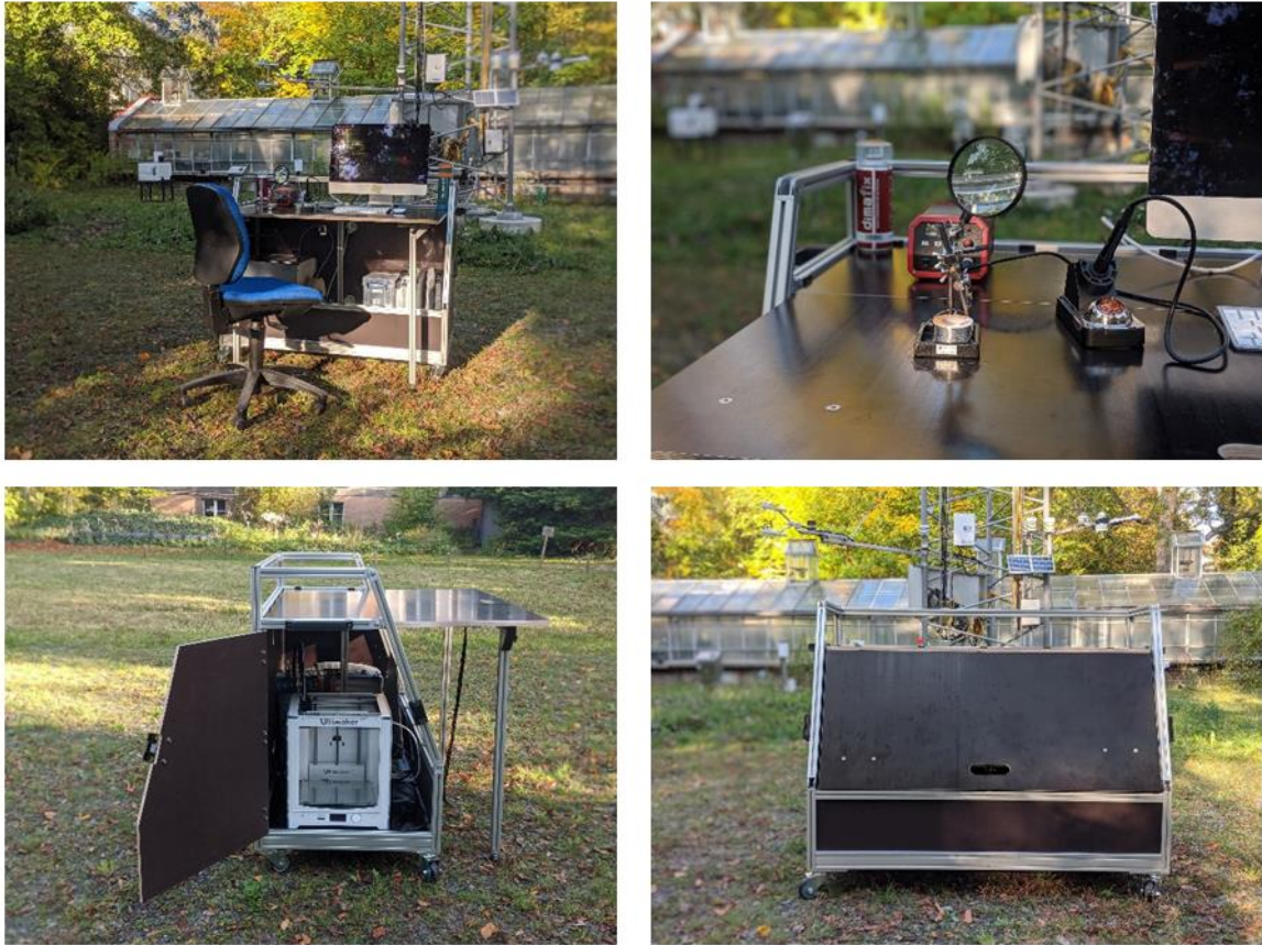
Abbildung 1 Vollständig aufgebaute mobiler Makerspace (oben rechts) mit Lötstation (oben links), 3_Drucker (unten rechts) und zusammengebaut für den Transport (unten rechts).
