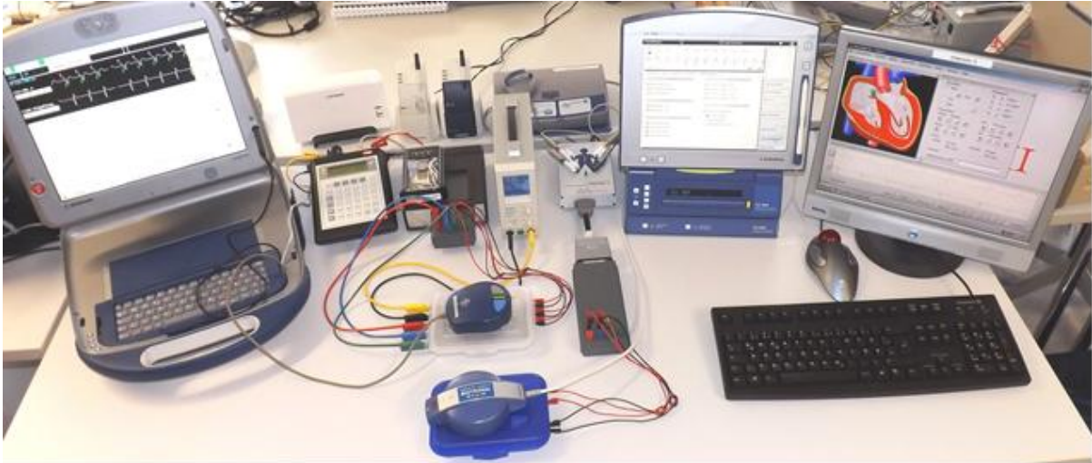
Abb. 1: Vorläufiger Prototyp eines Arbeitsplatzes mit Herzrhythmus simulatoren ARSI-IV und Intersim-II, Programmiergeräten Medtronic 2090 und Biotronik ICS-3000, Telemedizinssysteme CareLink und HomeMonitoring sowie einen PC zum Zugang auf die Internetportale der Telemedizinssysteme, zur Dokumentation und Qualitätssicherung.
