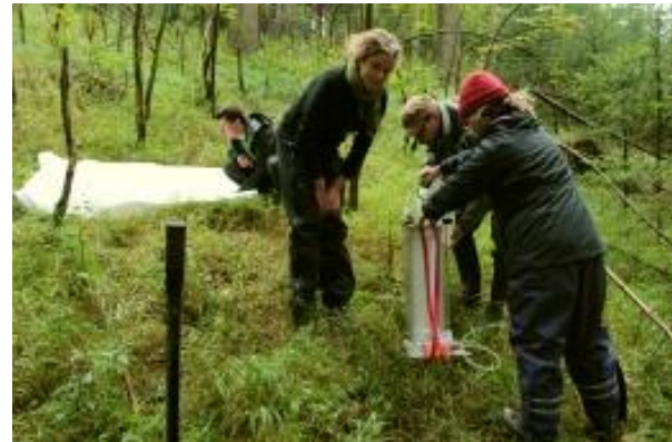
Amoozemeter-Messung der Infiltrationsraten
