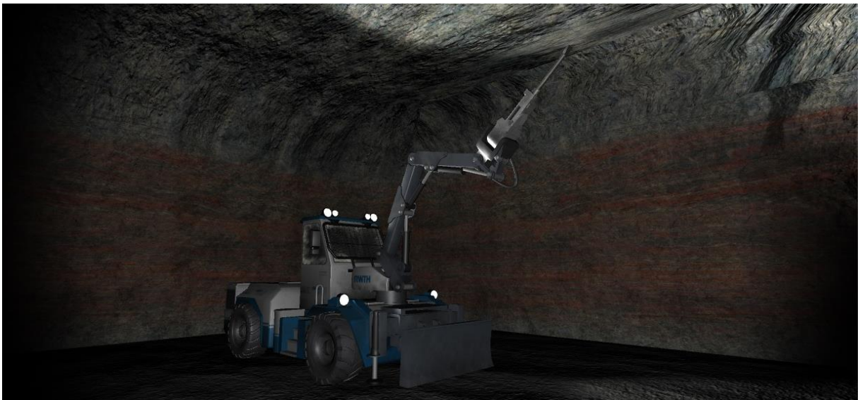
Abbildung 11 - Scaler überprüft die Firste auf lockere Gesteinsplatten
