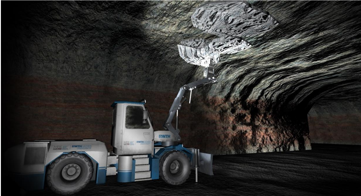
Abbildung 12 - Scaler löst Gesteinsplatte von der Firsche
