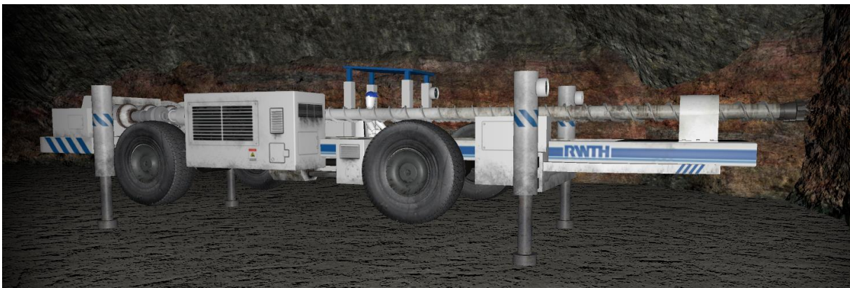
Abbildung 8 - Großbohrlochwagen in der Seitenansicht
