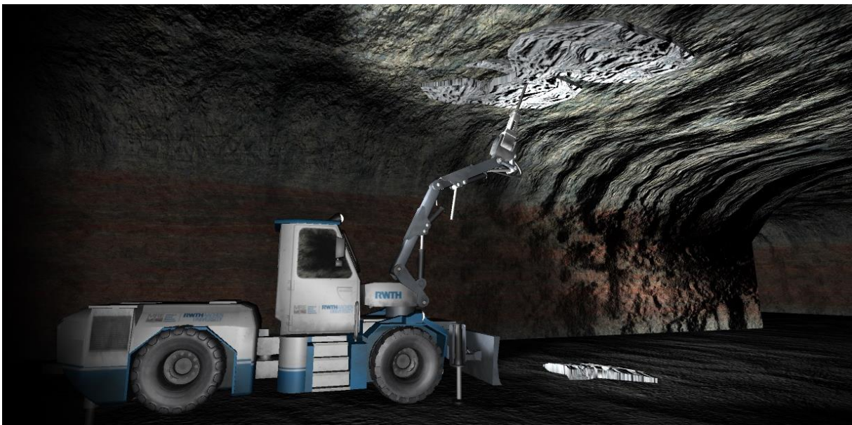
Abbildung 13 - Scaler mit gelöster Gesteinsplatte
