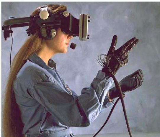
Abbildung: Eine Frau, die ein HMD (Head Mounted Display) mit einer vom Ames Research Center der NASA entwickelten Pop Optics-Brille und verkabelten Handschuhen trägt (2006). Public Domain Image: <http://gimp-savvy.com/cgi-bin/img.cgi?ailsxmzVhD80jEo694>; originally uploaded by ‚Bayo‘
