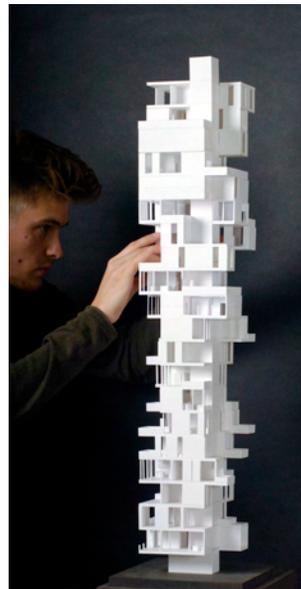
Abb.: 3D-gedruckter ‚Shared Tower‘ einer Studentengruppe im Maßstab 1:100 (Modellhöhe ca. 80 cm)
