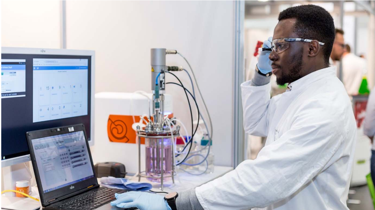
Abbildung 6: Demonstration des Smart-Glass Tutorials für Bioreaktoren auf der Biotechnica 2017 in Hannover durch Studierende der Hochschule Rhein Waal (Foto: itizzimo AG). Auf dem Notebook läuft die Software für den Betrieb des Applicon MyControl Bioreaktors, der große Monitor zeigt das simplifizier Dashboard und die Live-Darstellung der Brillenansicht.
