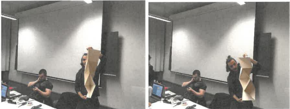
Ein Student der CTU Prag demonstriert das mechanische Verhalten seiner Faltstruktur. Links : Entfalteter Zustand erzeugt eine Minimierung des Volumens, Rechts : Gefalteter Zustand erzeugt eine Maximierung der Tragfähigkeit. Quelle: BioMat Documentation
